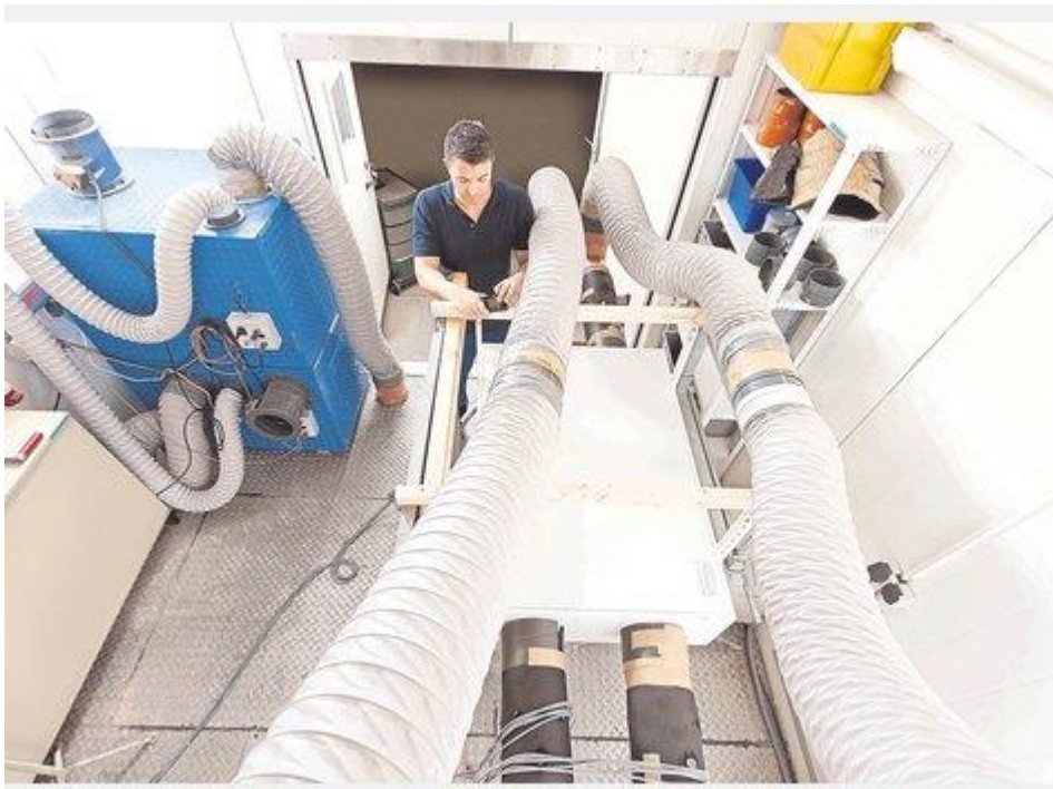
Beispiel für den Prüfaufbau eines Lüftungsgerätes in der Doppelklimakammer. Foto: tb
